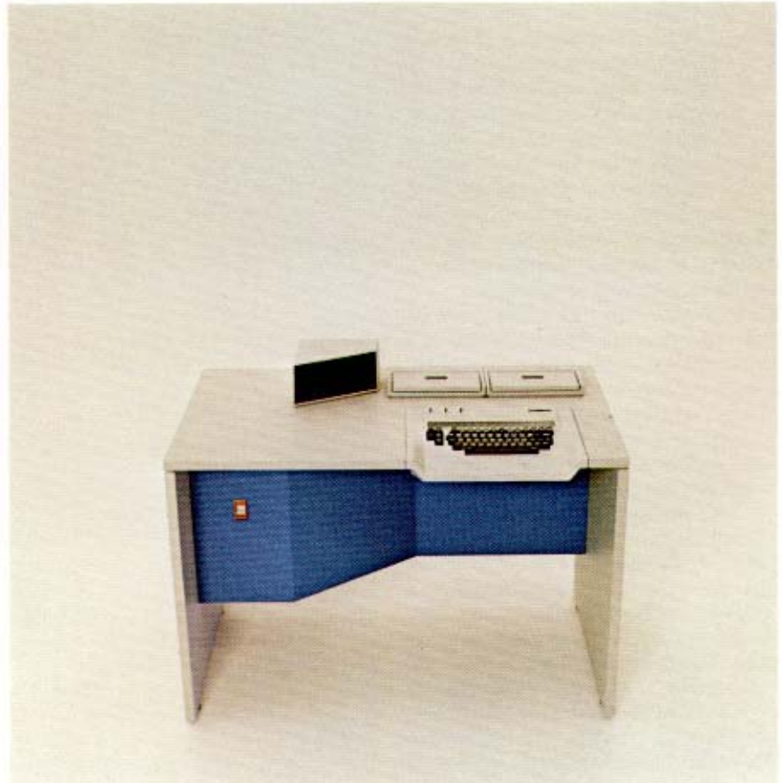
L'enregistreur 3741 équipé de deux unités de minidisques.
