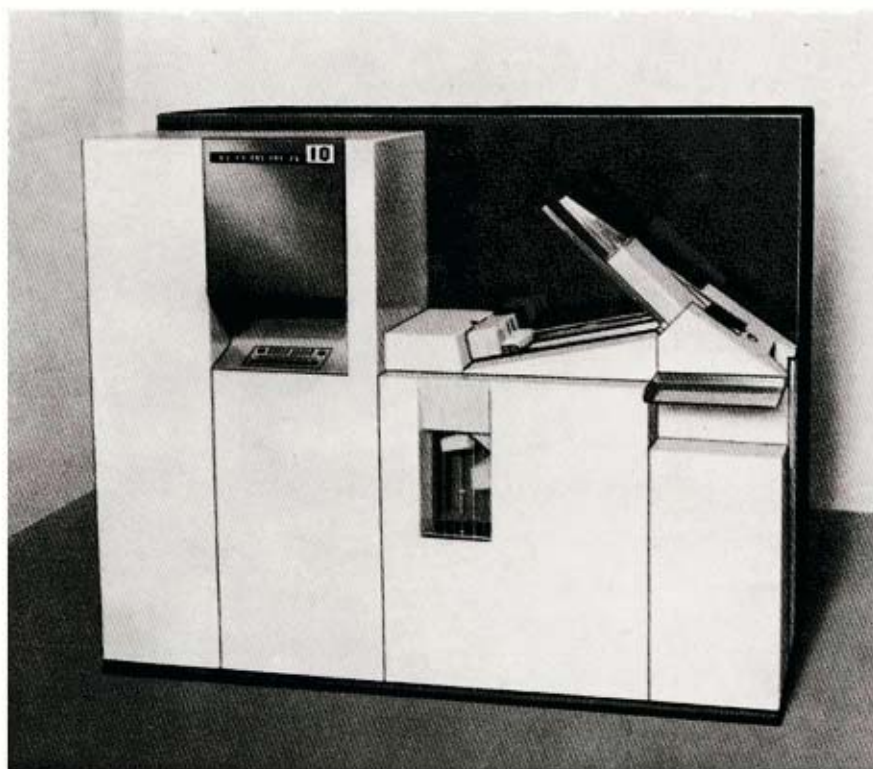
Vista parcial do Gamma 10 (unidade central e pista de leitura-perfuração); agrupadas num mesmo elemento compacto, estes dois órgãos oferecem ao operador um local de trabalho funcional.
