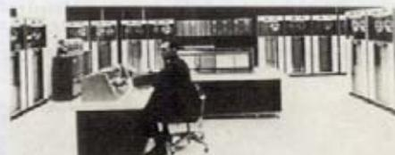
*A grande velocidade do IBM 7080 era um exemplo daquilo que o transistor significava para a computação. Os mesmos programas utilizados para pagamentos de salários, facturação e inventários são executados pelo 7080 a uma velocidade seis a dez vezes superior à do computador anterior, o IBM 705.*
