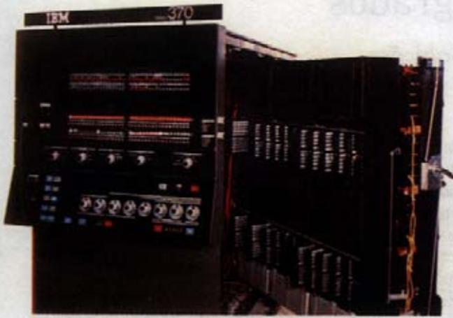
O Sistema/370 Modelo 145 da IBM, apresentado em 1971, utiliza a primeira memória central de computador feita inteiramente de tecnologia de circuito integrado monolítico. O Modelo 145 continha inicialmente até 131 placas de circuito, montadas na porta que está aberta. Esta quantidade de placas continha para cima de 262 000 caracteres de informação, que poderiam ser lidos em 200 bilionésimos de segundo cada um.
