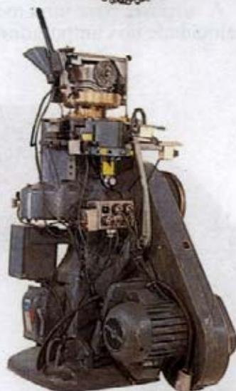
A IBM adaptou, nos anos 50 e 60 máquinas de fabricação de comprimidos a fim de fabricar dezenas de milhões de anéis. Em cima vê-se uma máquina da Colton Manufacturing Co., readaptada pela IBM para comprimir pó de ferrite e produzir 32 000 anéis por hora. Entre muitas outras técnicas automatizadas, a IBM concebeu um alimentador de fios para enfiar, numa só operação, milhares de anéis.
