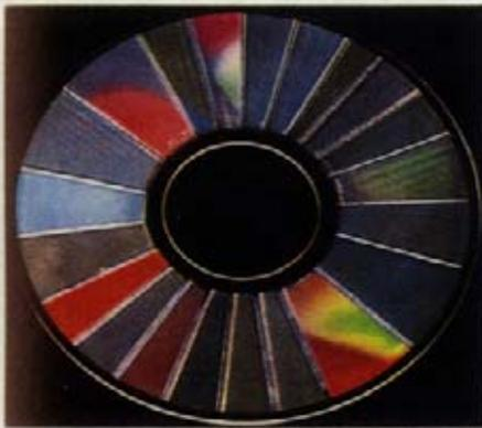
O «scanner» é aplicado aos terminais de caixa de supermercados fabricados pela IBM e incorpora um disco rotativo de 21 camadas holográficas, que funcionam como prismas de vidro e como lentes. Um raio laser passando através do disco, cria um complexo padrão de luzes que incidem sobre as listas codificadas que existem hoje em muitas embalagens e que são lidas pelo «scanner». A luz reflectida das listas é convertida em sinais eléctricos para processamento por computador.
