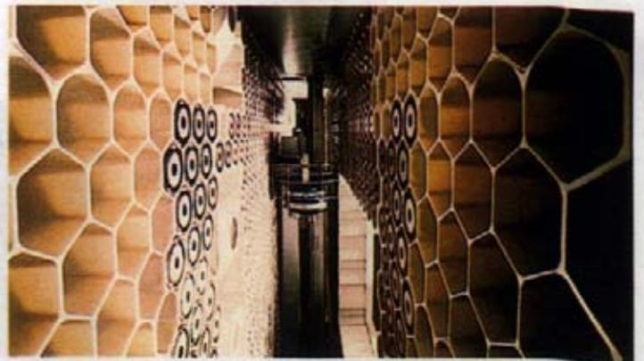
A estrutura das células em forma de favo, do sistema de armazenamento em massa, do IBM 3850 apresentado em 1976, armazena pequenas cassetes contendo bobines de fita magnética. Cada bobine pode armazenar 50 milhões de caracteres de dados. Para cima de 472 bilhões de caracteres podem ser arquivados economicamente num sistema 3850 para utilização «on-line» no computador.
