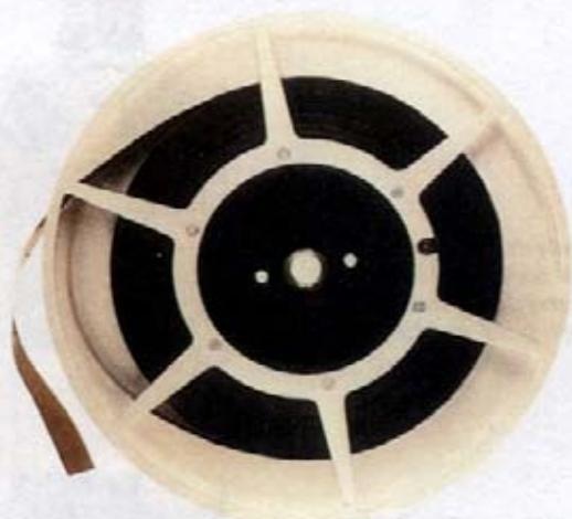
Em 1952 o sistema IBM 701 foi um dos primeiros a utilizar bandas magnéticas para leitura, gravação e armazenamento de dados. Sendo gravada a 100 caracteres por polegada, esta bobine, de 8 polegadas de diâmetro, era equivalente a 12 500 cartões perfurados. As unidades de bandas do 701 continham uma nova coluna de vácuo e sistema de embraiagem magnética e foram dos primeiros a utilizar plástico em vez de metal.
