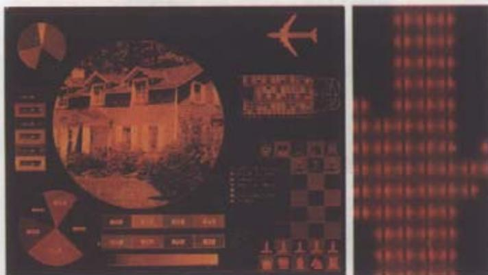
A técnica de vídeo de painel de gaz apresentada pela IBM em 1983, produz imagens sem cintilações a partir duma grelha de fios com 3/4 de milhão de intersecções. Gaz ionizado de neon/argon brilha em pontos de intersecção seleccionados (foto da direita) para produzir caracteres e desenhos de alta resolução. As técnicas desenvolvidas pela IBM, para a fabricação com alta precisão da grelha de fios produzem uma grande qualidade de imagem.
