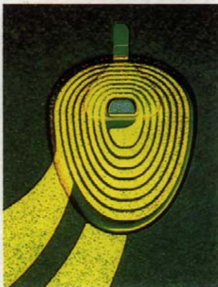
*Aumentada várias centenas de vezes, esta espiral de cobre faz parte do «thin film», delgada cabeça gravadora, utilizada em vários discos da IBM. A unidade de discos IBM 3380 que utiliza a tecnologia para ler e escrever dados à velocidade de 3 milhões de caracteres por segundo é a primeira unidade comercial a conseguir tal velocidade (refracções de luz de camadas separadas por espaços minúsculos produzem padrões de cores iridescentes).*
