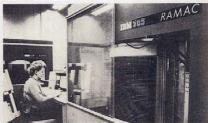
O processamento de dados tomou novo rumo em 1957 com a entrada no mercado do IBM 305 RAMAC, o primeiro computador com o sistema de armazenamento por disco. Tais máquinas tornaram-se o meio de armazenamento básico da indústria para o processamento de transacções «on line». Em menos de um segundo o RAMAC, com o seu braço de acesso aleatório conseguia ter acesso aos dados armazenados em qualquer dos seus 50 discos em rotação.
