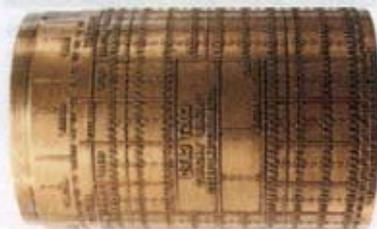
Este cilindro de impressão de três polegadas e meia pertence à primeira máquina que produziu comercialmente a alta velocidade cartões perfurados — a Impressora Carroll desenvolvida pela IBM em 1924. A impressora rotativa rápida foi a resposta às necessidades da indústria para o fornecimento anual de biliões de cartões perfurados.
