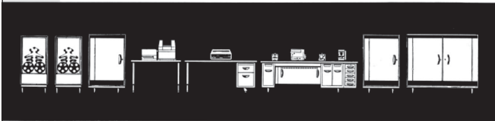
Équipement comprenant : des organes d'entrée sur bande et cartes perforées, un perforateur de bande et 2 unités de films magnetiques
